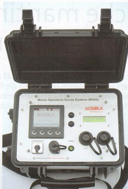
Im Marine Operations Survey System MOSS dient ein Bediengerät vom Typ D1000 als Benutzerschnittstelle
